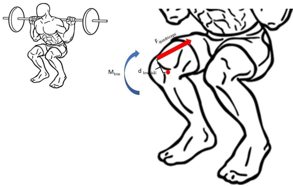
6. I den dypeste posisjon skapes det et dreiemoment rundt kneleddet ( $M_{\text{kne}}$ ) på 120Nm. Kneleddets kraftarm ( $d_{\text{kneskål}}$ ) er 4 cm. Hva er kraften skapt av m. quadriceps ( $F_{\text{quadriceps}}$ )? (3 poeng)
